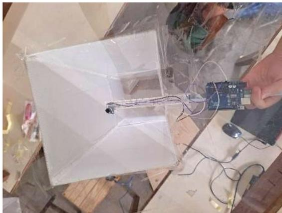
圖十七 測量玻璃門片實際的溫度計設置
