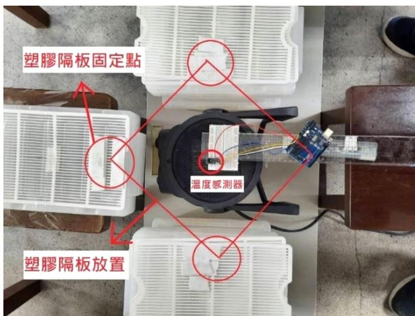
圖十六 塑膠隔板固定方式
