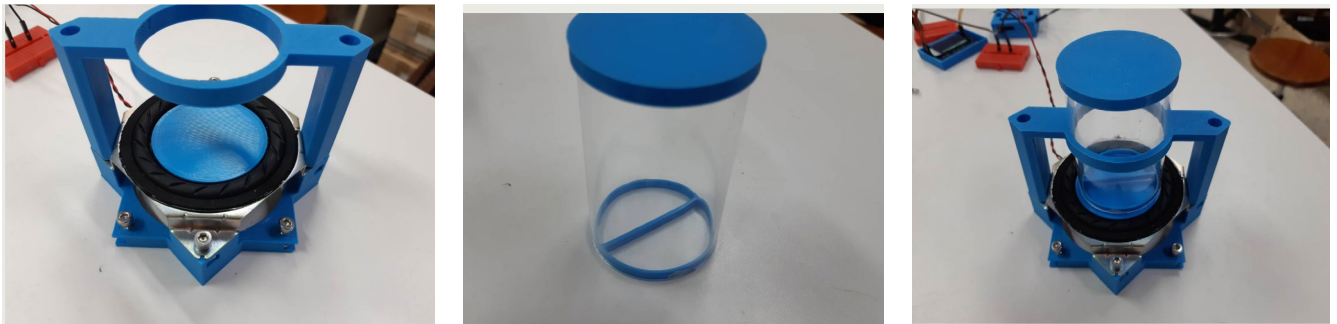
圖七：(a) 支撐透明壓克力圓柱支架；(b) 透明壓克力圓柱與 3D 列印圓柱隔板；(c) 3D 印件的實驗組合圖。
