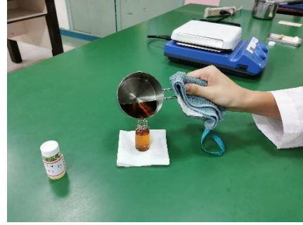
圖(七)、油品加熱、溫度控制、收集。
