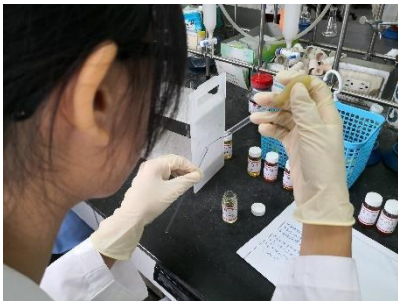
圖(八)、準備食用油樣品至核磁共振光譜儀測量管
