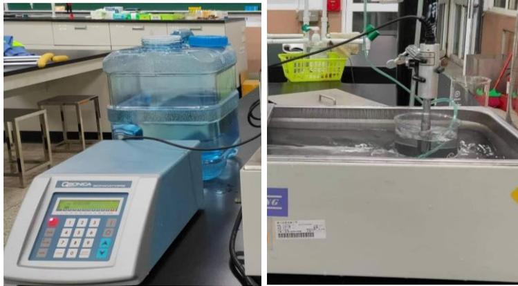
圖二十六、二十七:恆溫槽及超音波震盪器配置
