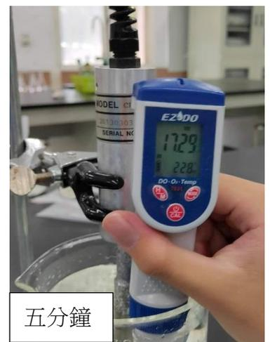
圖十八:每分鐘溶氧量測量圖
