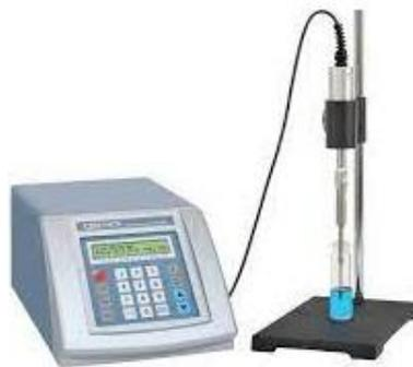
圖十一:筆型超音波震盪器
