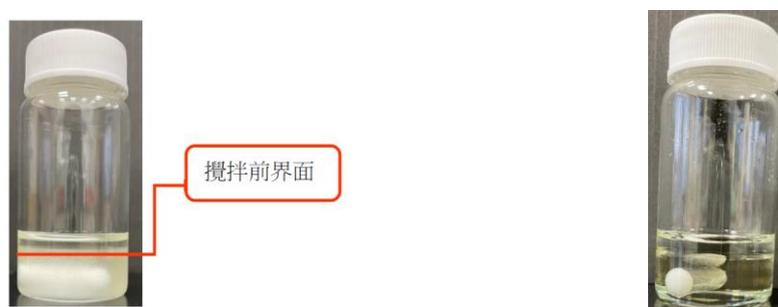
圖十六：乙醇1.8mL+沙拉油4.2mL(攪拌停止後) 圖十七：乙醇1.8mL+沙拉油4.2mL(靜置後)
