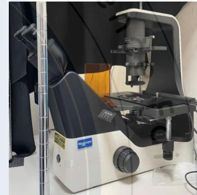
圖六：倒立螢光照相顯微鏡
