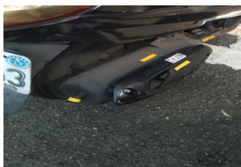
圖三十九：機車發動後粉末顏色 2、越接近引擎處的溫度越高，試紙顏色也越出現顯著差異。
