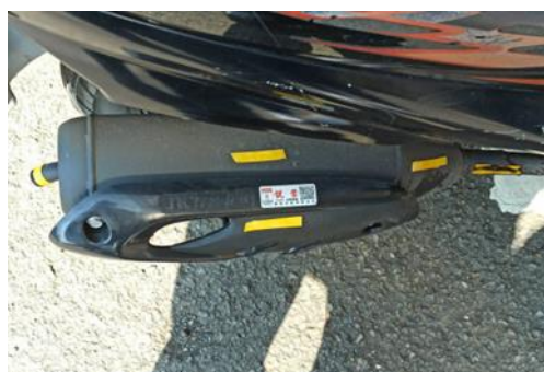
圖四十：機車發動後粉末顏色變化 3、機車啟動 20min 後，溫度大於 240 度的地方已呈現黑色，而中間處也變橘，溫度約 120 度
