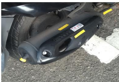
圖三十八：鈷黃粉末尚未變色前 1、我們將鈷黃粉末製成試紙，將試紙貼於排氣管各處。
