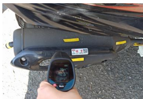
圖四十三：熄火後排氣管溫度 6、降至 42 度時顏色已回到原本的顏色，而變成黑色的地方無法變回黃色
