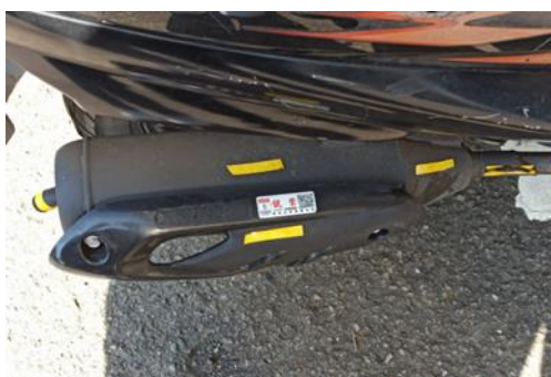
圖四十二：機車熄火降溫後粉末顏色 5、熄火後排氣管靜置到顏色開始變回黃色，觀察顏色恢復情形。
