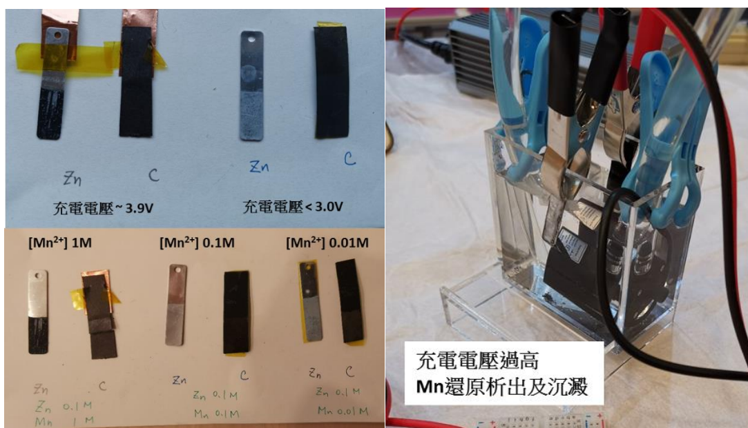
圖七：較高充電電壓造成的 Mn 還原析出與沉澱
