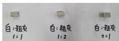
圖三十五：白水泥與粗灰水泥之不同混合比例的小型成品 白水泥與水泥砂之質量混合比例分別為 1：1、1：2 與 2：1 的小型成品，如圖三十六所示
