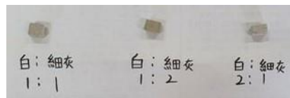
圖三十四：白水泥與細灰水泥之不同混合比例的小型成品
