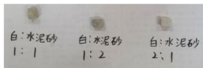
圖三十六：白水泥與水泥砂之不同混合比例的小型成品
