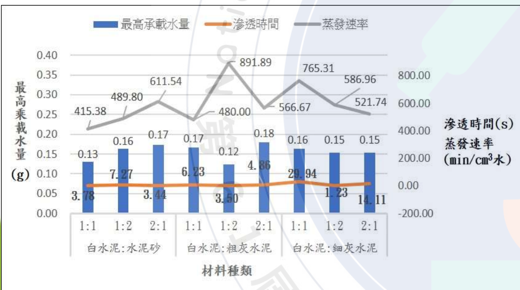
不同混合比例的小型成品與最高承載水量、滲透時間和蒸發速率之關係圖
