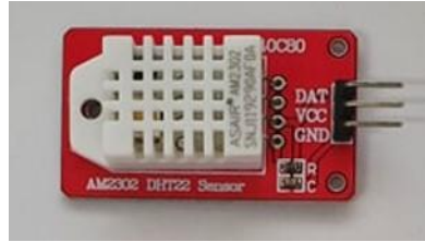
圖十四：DHT22 溫溼度感測器
