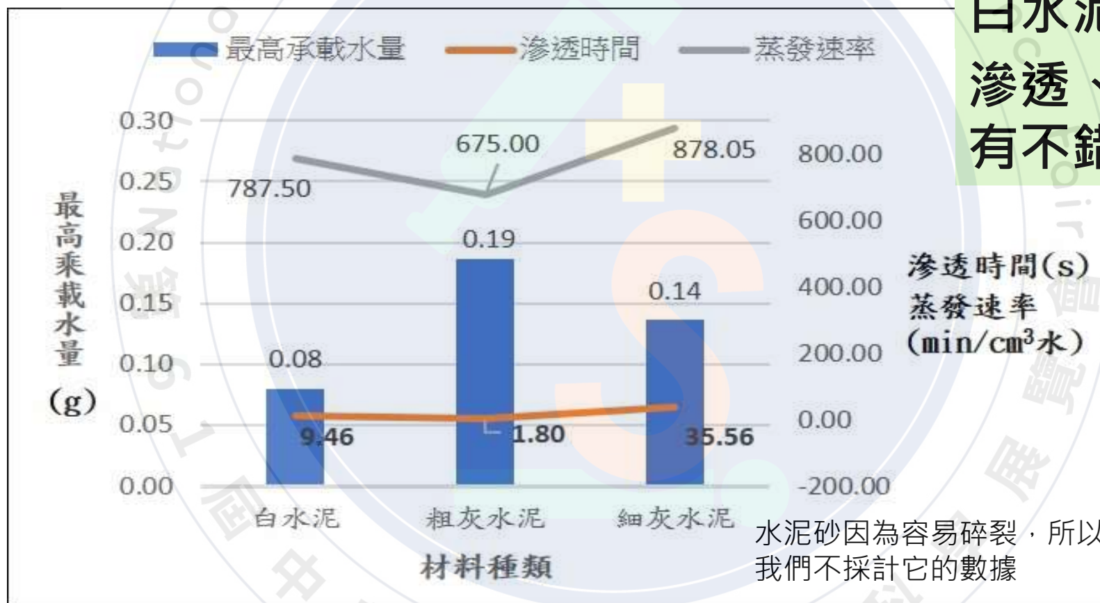
不同材料的小型成品與最高承載水量、滲透時間和蒸發速率之關係圖
