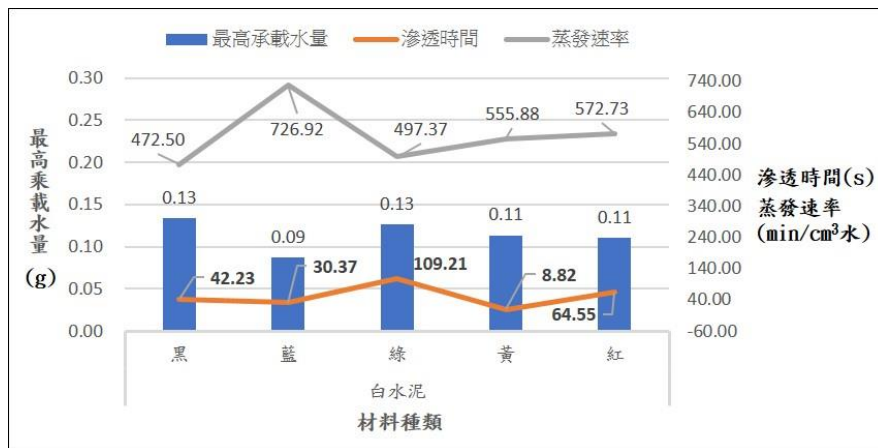
圖四十：不同顏色的小型成品與最高承載水量、滲透時間和蒸發速率之關係圖
