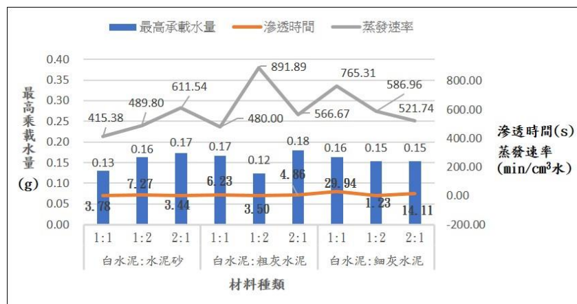
圖三十九：不同混合比例的小型成品與最高承載水量、滲透時間和蒸發速率之關係圖
