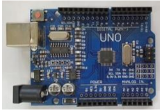
圖十三：Arduino UNO 控制板
