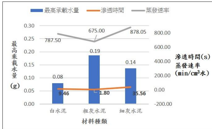
圖三十八：不同材料的小型成品與最高承載水量、滲透時間和蒸發速率之關係圖
