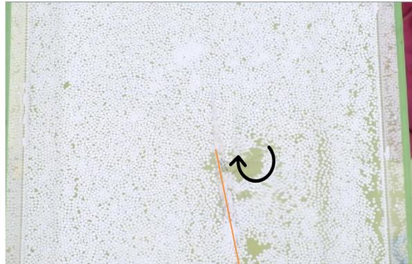
圖 26-1 尾鰭擺到最右時渦流情形(推力佳) 圖 26-2 尾鰭擺到最左時渦流情形(推力佳)
