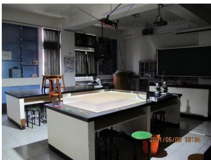
圖 4 自製壓克力水波槽
