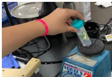
圖 20a 震動器模擬搓洗動作
