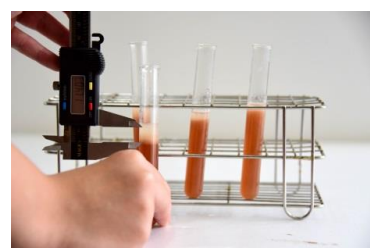
圖 16 測量油高比例
