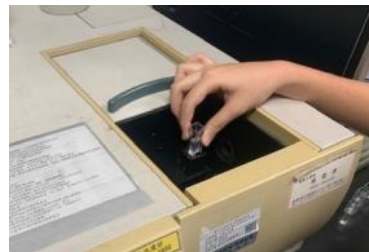
圖 20b 光度計測量單寧酸殘留
