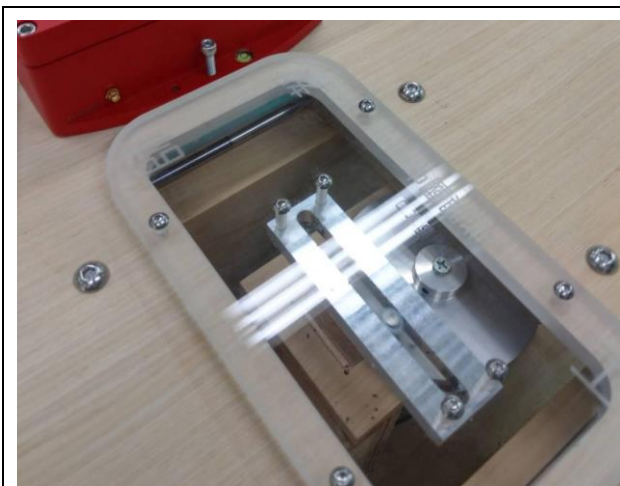
圖 7 振動平台的搖擺機構_蘇格蘭軛
