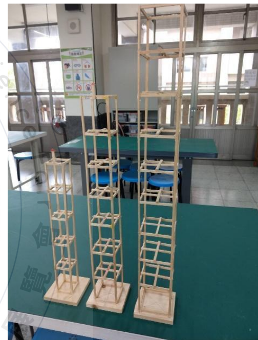
自製模型結構 (皆使用4*6mm木條)
