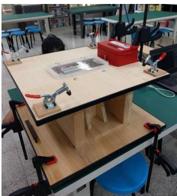
圖 5 將加速規固定在振動平台上，振動平台也要使用夾具與桌面固定。
