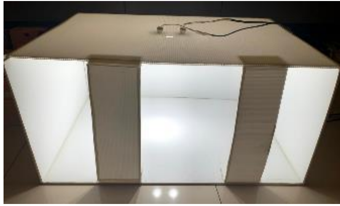
圖四、拍照裝置。由白色PP板製成長75cm、寬52cm、高37cm的拍照箱
