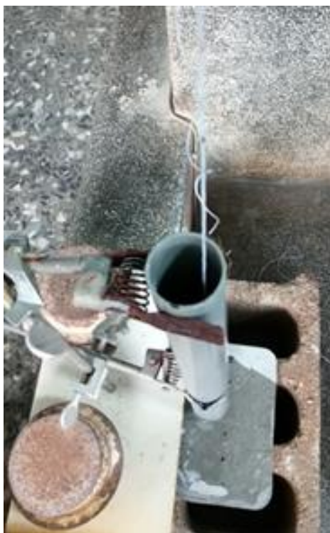
吊錘吊線墜砵撞擊水泥樣本
