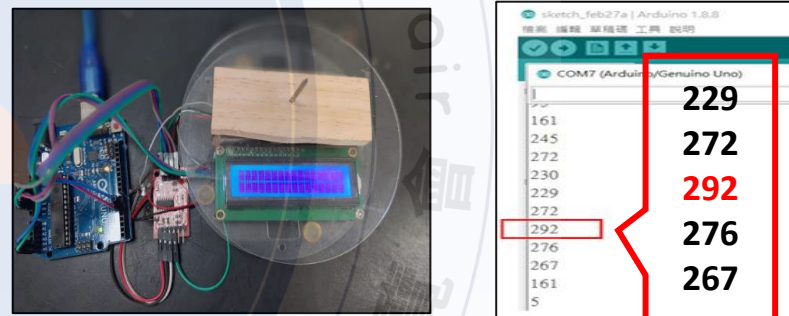
圖3 穿刺強度測量示意圖
