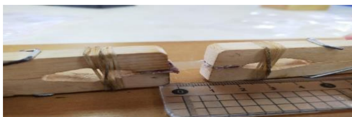
圖 5-2-4-2 彈性測量實際裝置圖
