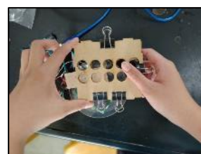
圖 5-2-3-5 穿刺強度實際測量裝置
