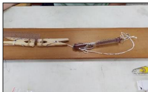
圖 5-2-2-2 抗張強度測量實際圖
