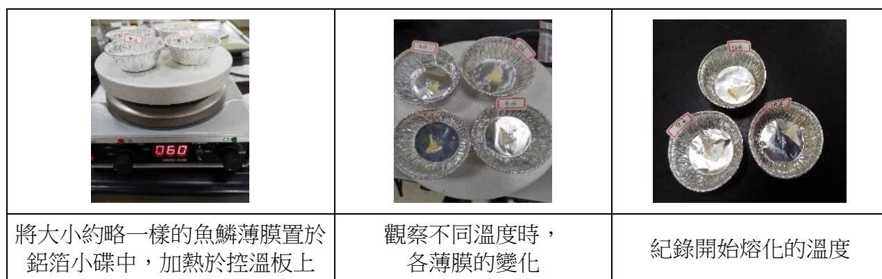
圖 5-4-6-2 測量魚鱗薄膜的膠熔溫度
