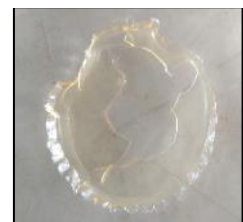
圖 5-4-5-3 不加甘油所製成的魚鱗薄膜很硬且脆
