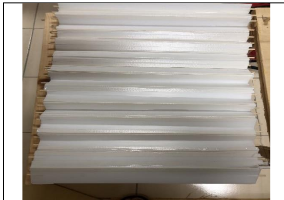
圖 4-12 雨遮 1.0 展開的實驗情形
