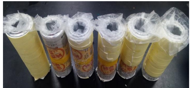
照片 5-6-1 不同散熱面積的結冰鋁罐
