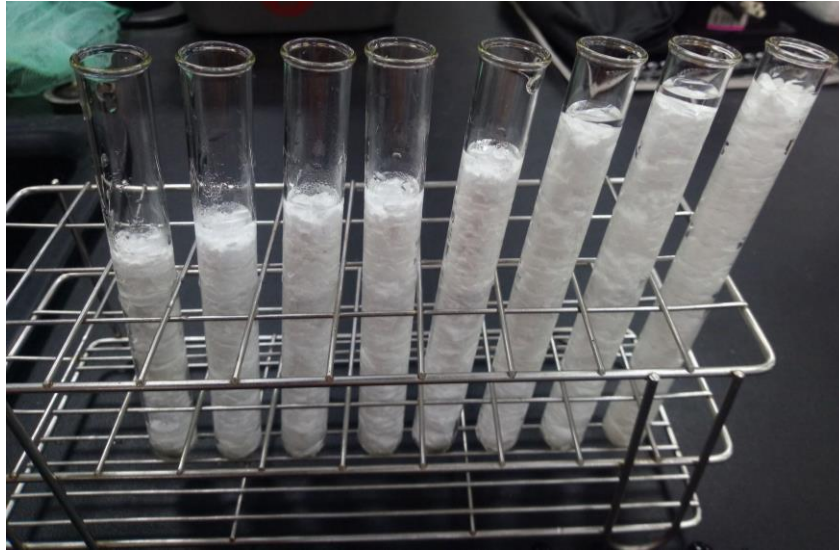
圖 5-3-2 不同水體高度對結冰率的實驗裝置
