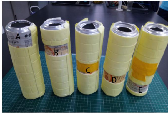
圖 5-4-6 吸熱位置對結冰率實驗裝置
