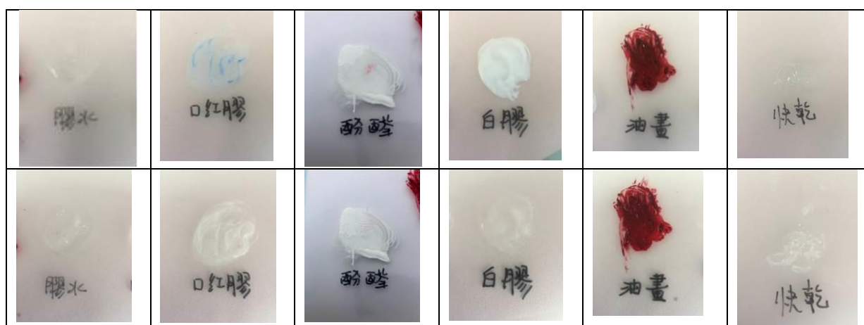
圖 5 上方為剛塗完膠類物質，下方為乾燥後結果
