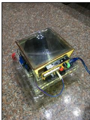
圖 7-3 白天光線充足時，複合式方電裝置將電能儲存於電池中
