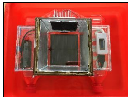
圖 5-10-2 漂浮發電裝置 在水中漂浮狀況測試
