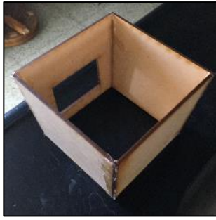
圖 5-8-1 雷切機製作似天燈型的蓄熱裝置
