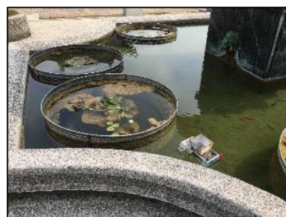
圖 5-10-4 放置在學校池塘的漂浮發電裝置 在太陽的照射下，成功充電於電池上
