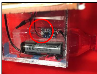
圖 5-10-3 漂浮發電裝置在 鹵素燈的照射下，成功充 電於電池上
