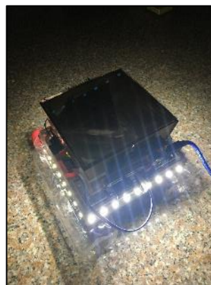
圖 7-4 夜間光線不足時，利用白天儲存在電池中的電能輔助照明
