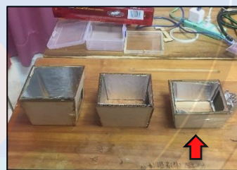
圖15 蓄熱器側面太高會遮住太陽光， 因此選用較低的側板(箭頭所指)
