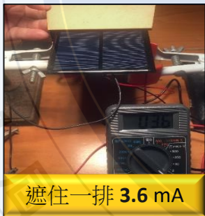
圖14 太陽能板被遮住，電流下降許多
