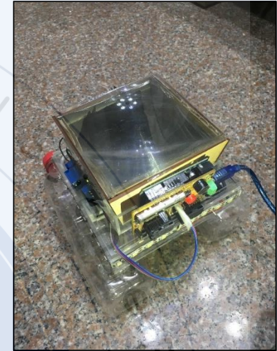
圖17 白天光線充足時，複合式發電裝置將電能儲存於電池中
