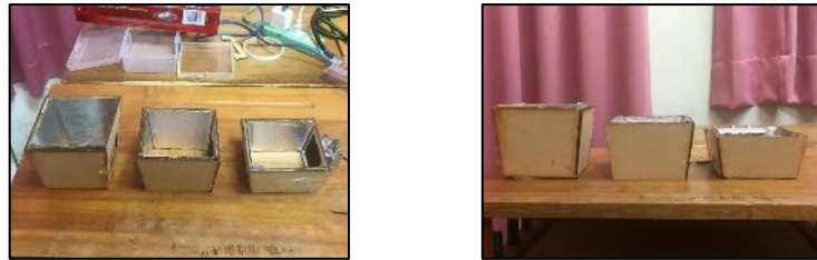
圖 6-7 上下底皆為 10 cm、12 cm，但高度依序為 10、8、6 cm 的蓄熱器側邊
