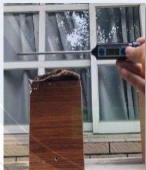
測量隔熱模型屋 屋內及屋外溫度
