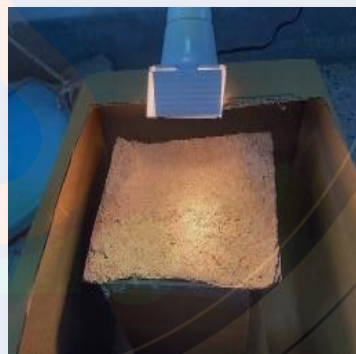
測量隔熱模型屋在室內燈光下屋內及屋外溫度
