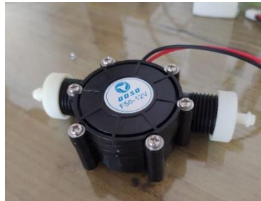
圖 5.22、第 4 代濾水裝置的水力發電模塊(加上自製轉接器)
