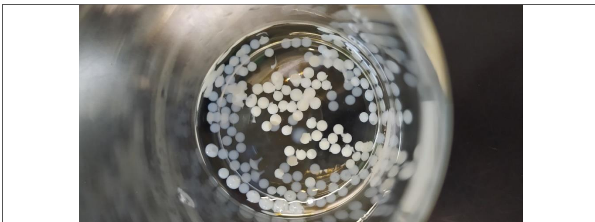
圖 5.6 幾丁聚醣溶液與氫氧化鈉溶液反應形成水膠圓珠過程
