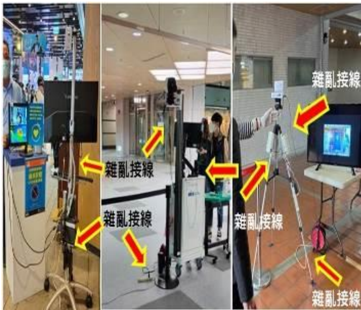
圖3-4 系統整體接線凌亂複雜。資料來源:網路/新聞
