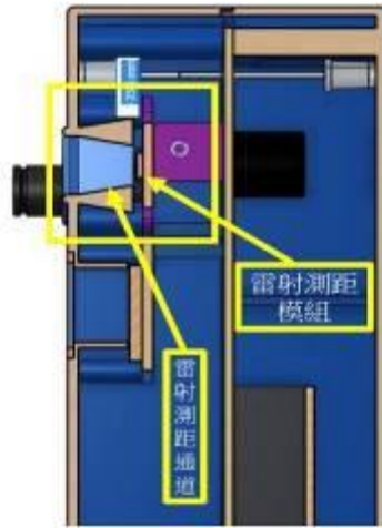
圖 8-23 重新設計雷射測距通道邊緣角度
