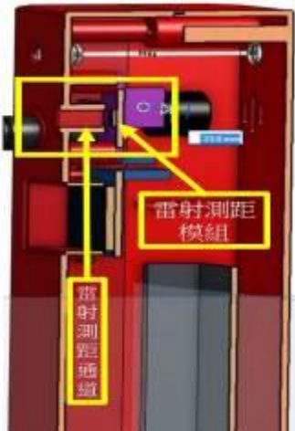
圖 8-22 直線雷射測距通道造成干擾
