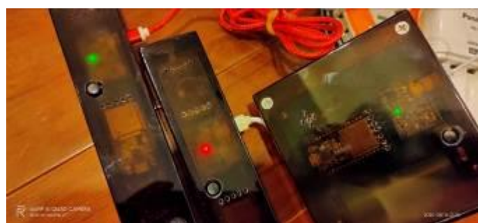
圖7-9 機板組裝入壓克力外殼完成圖
