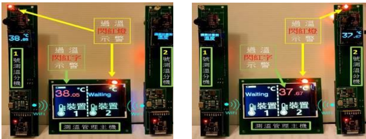
圖8-11 2.0版測溫分機與管理主機過溫測試--分機主機協作模式，1號分機測得過溫(左)，2號分機測得過溫(右)
