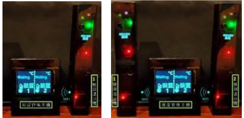
圖 9-3 單測溫分機與管理主機協作模式 圖 9-4 雙測溫分機與管理主機協作模式
