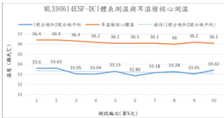
圖7-24 體表測溫與核心測溫比較
