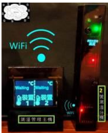
圖 9-5 單測溫分機與管理主機協作雲端數據鏈模式
