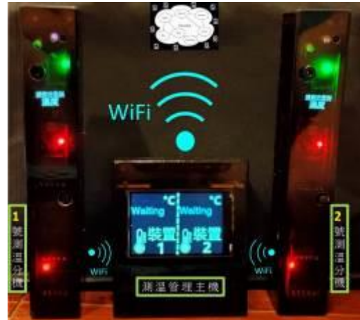
圖 9-6 雙測溫分機與管理主機協作雲端數據鏈模式
