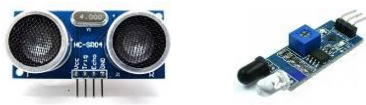
圖6-4 超音波測距模組(左)與紅外線測距模組(右)體積比較
