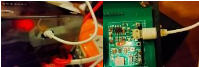
圖7-11 插槽孔位缺陷，測溫分機(左)，管理主機(右)
