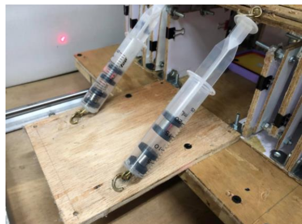
圖 36 單側磁鐵同極相斥阻尼器安置圖
