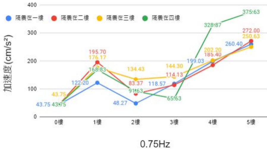
圖 30 隔震裝置安裝於不同樓層時，於地震頻率 0.75Hz 下之各樓層與加速度關係圖
