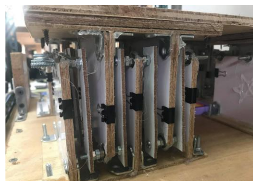
圖 7-2 隔震裝置完成圖
