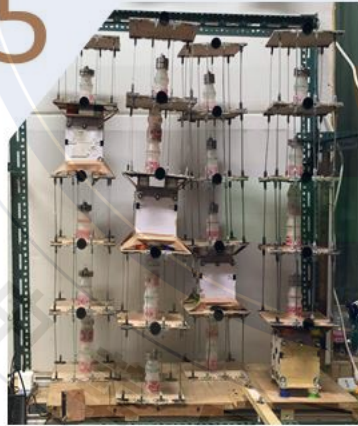
隔震裝置安裝的樓層
