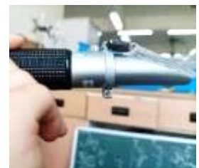
圖 5-4-6：以鹽度計測量鹽度
