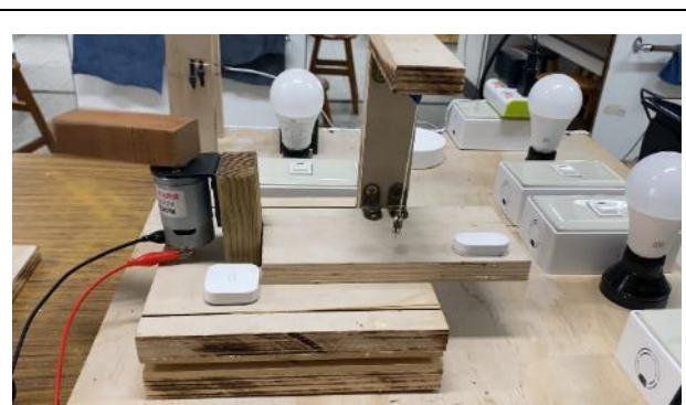
2.低電壓時地震平台震動幅度小,單擺的擺幅也比較小
