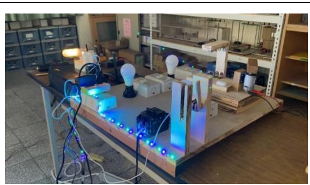
12.當發生斷電時，UPS 自動開啟使小夜燈、LED 燈條和大門門鎖正常運作
