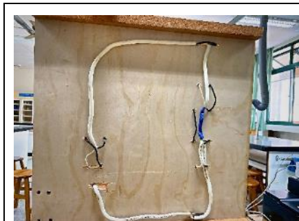
圖 26、將 2.0mm 電線穿過木板並在木板底部配線
