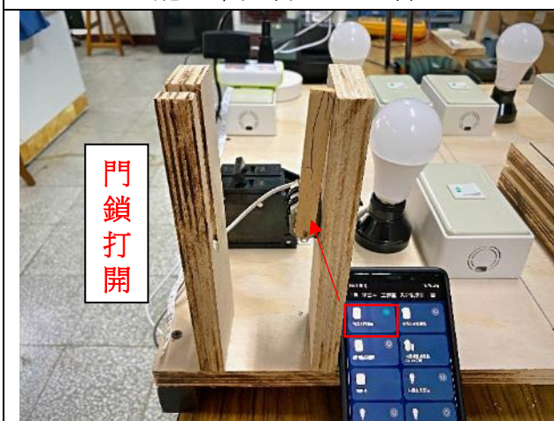
圖 44、手機 APP 軟體中大門的智能插座打開，門鎖打開
