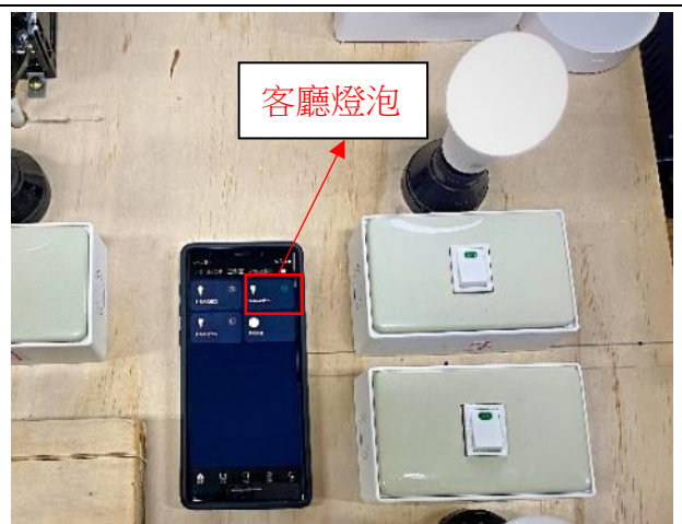
圖 39、用 APP 軟體依序測試三個智能燈泡是否能夠正常開啟
