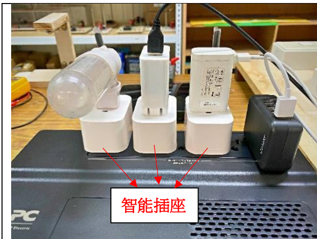
圖 40、將三個智能插座安裝在 UPS 上再將小夜燈、LED 燈條和門鎖插在智能插座上
