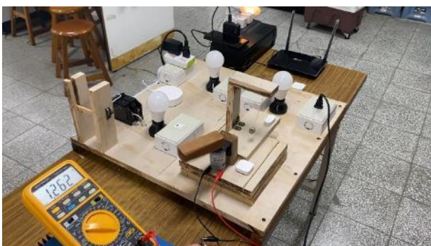
7.當電壓加大到使震度達到 4 級時，門窗感應器發生感應，小夜燈自動開啟
