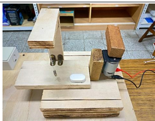
圖 21、結合地震震動平台和地震感應器
