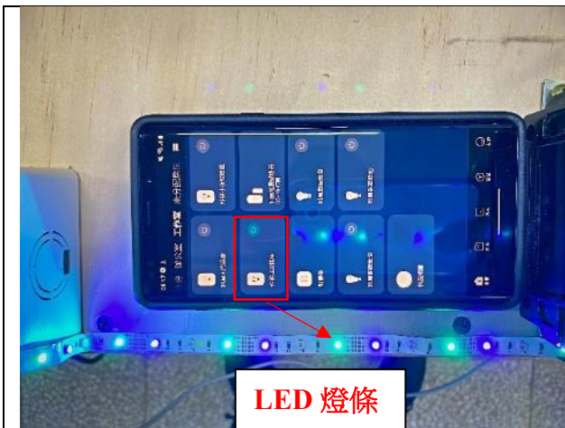
圖 42、利用手機 APP 軟體測試智能插座是否能正常控制 LED 燈條
