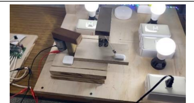
10.當震度 4 級時，單擺的擺動幅度大到能使強力磁鐵和門窗感應器之間發生感應
