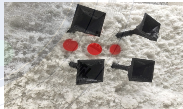
坡地鑽入立柱與樹根並加裝雨水收集器降雨結果
