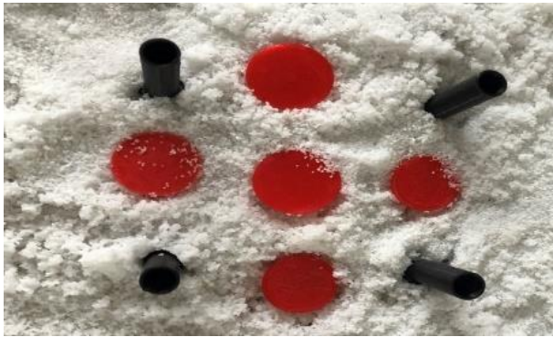
圖 5-5-6、坡地鑽入立柱與樹根降雨後結果
