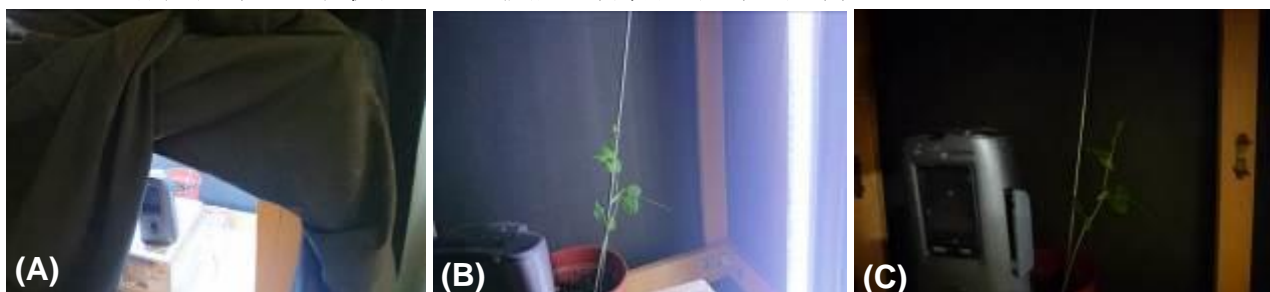
圖四、實驗觀察屋的黑暗環境裝置和豌豆捲鬚纏繞觀察試驗。(A)以大黑布罩住木架作為「黑暗」實驗觀察屋；(B)LED白光燈置於實驗觀察屋的側方，作為側光來源；(C)在黑暗觀察屋內架置縮時攝影機拍攝豌豆葉捲鬚的觸竿纏繞表現。
