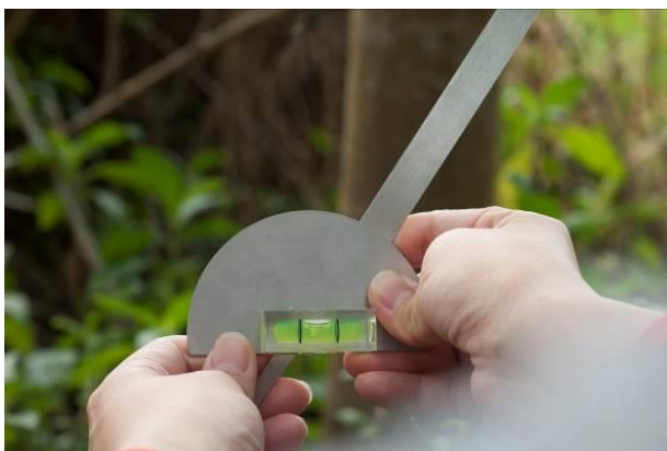
圖四、以黏上水平儀之量角器量取蜘蛛網角度
