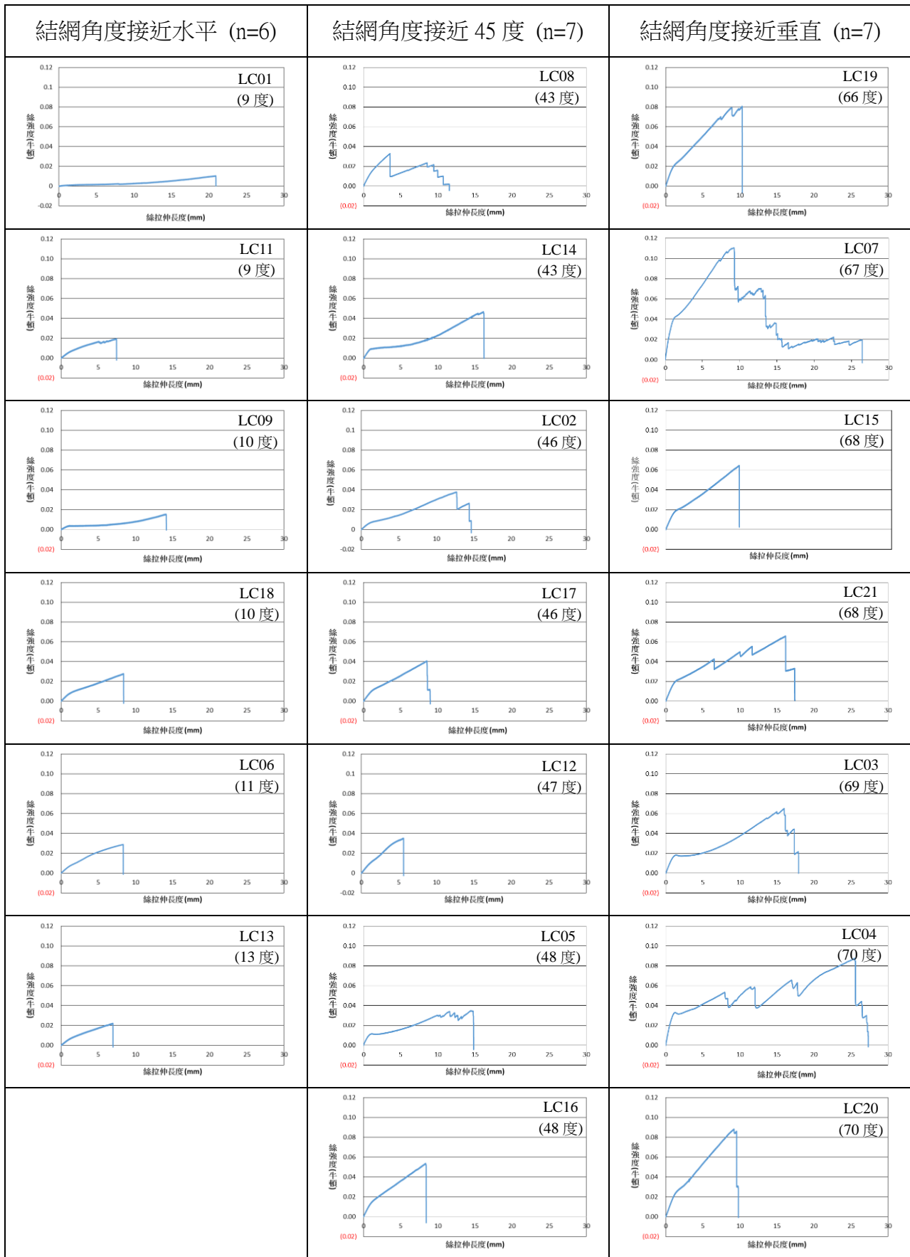
圖二十五、以拉伸測試儀測得西里銀腹蛛不同結網角度縱絲之絲強度曲線變化圖；縱軸為絲強度，單位為牛頓；橫軸為絲拉伸長度，單位為 mm
