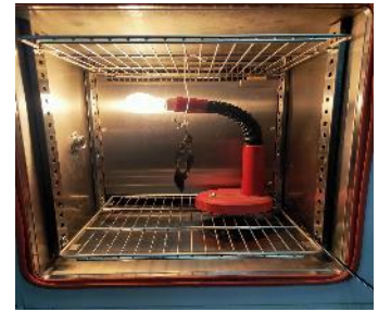
圖 20：模擬輻射熱裝置
