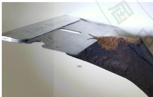
圖3：切片剖析內部結構
