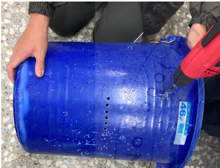
製作水位固定的試驗桶
