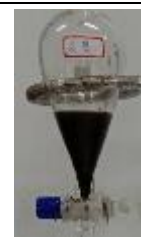
【圖】由分液漏斗、滴管、吸管頭組裝而成的控制裝置
