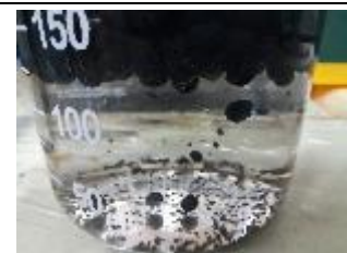
【圖】表面張力作用與重力平衡
