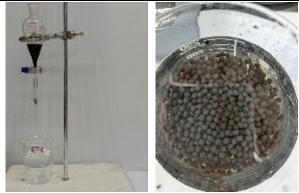
【圖】由分液漏斗、滴管、吸管頭組裝而成的控制裝置
