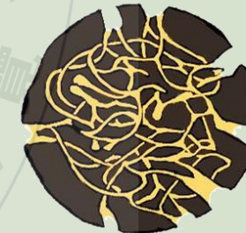
【圖3】產生CO 2 撐破石墨結構
