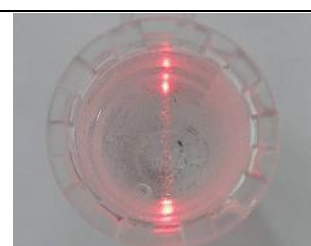
【圖】泡酸烘乾出現的白色粉末使用「水」溶解具有廷得耳效應
