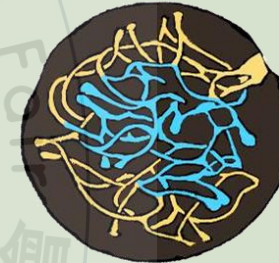
【圖2】絕氧加熱時，CaCO 3 逐漸轉換為CaO
