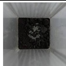
【圖】龍殼酸洗後窯燒後再泡酸烘乾，沒有出現白色粉末。表示事先酸洗能有效移除鈣鹽。
