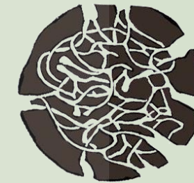
【圖4】產生更多間隙，使酸更容易入侵腐蝕石灰
