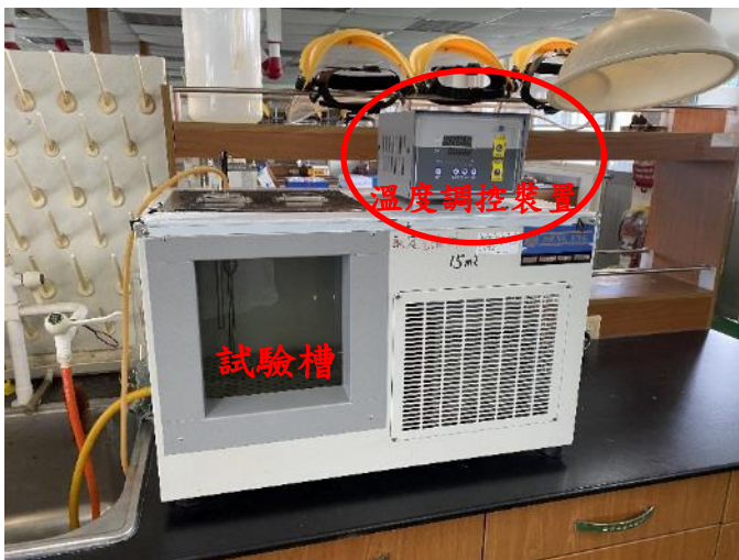
圖 23. 黏度試驗水槽。溫度設定為 40 °C。
