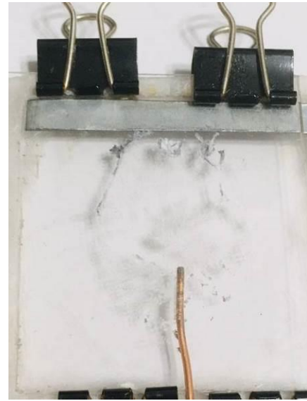
圖八(2)：將電解濃度 1 \times 10^{-2} M 硫酸鋅溶液，鋅金屬生長結果放置四天。
