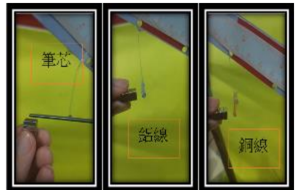
圖 31 三種物質之垂吊法實驗圖
