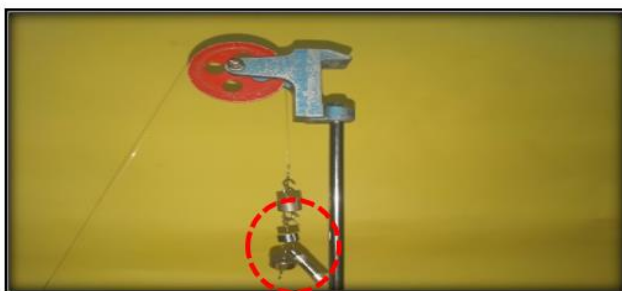
圖 4-1 圓磁鐵會吸住支撐桿(定滑輪組)
