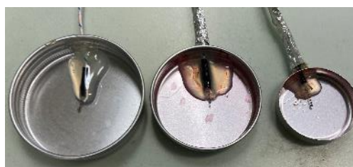
圖 29 用 K-type 熱耦溫度計測量燃燒中的甲醇溫度。大中小三種火力是分別用鋁盒 C、B、A 的蓋子裝甲醇燃燒。
