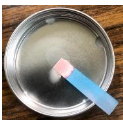
圖 28 藍色氯化亞鈷試紙檢驗火龍捲燃燒後留下含水的殘留物。
