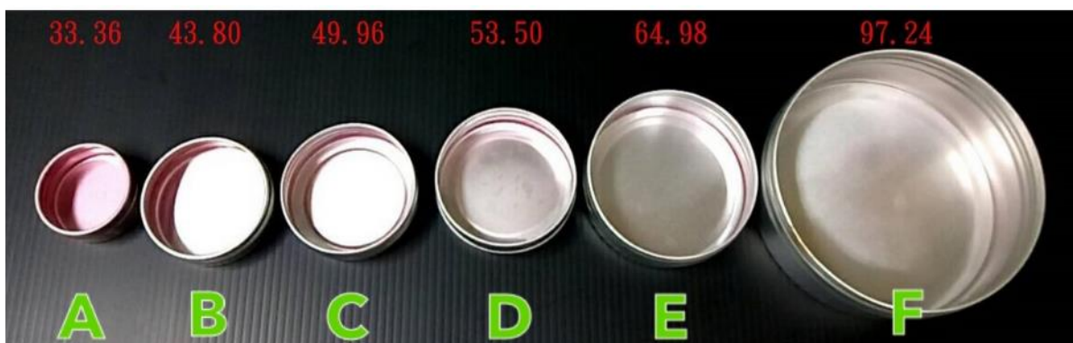
圖 4 盛裝燃燒甲醇的六種不同大小的鋁盒及代號，圖中數字標示鋁盒內直徑（mm）。
