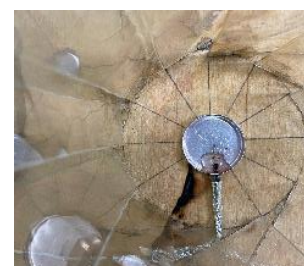
圖 30 將有 K-type 溫度計的鋁盒放進裝置後裝入八分滿甲醇燃燒。
