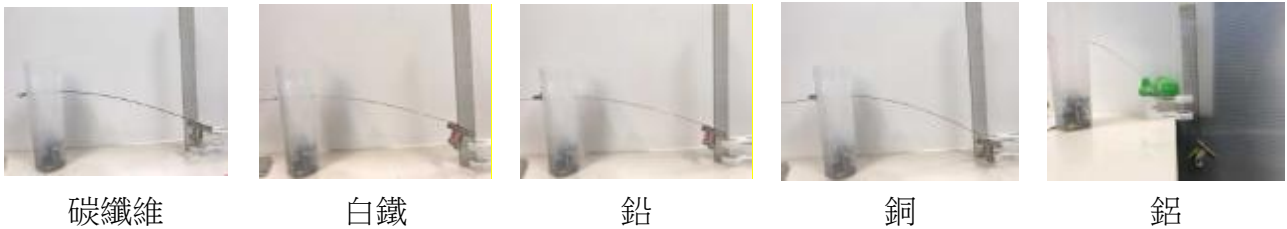
圖 1 尋找柳擺合適材質裝置圖
