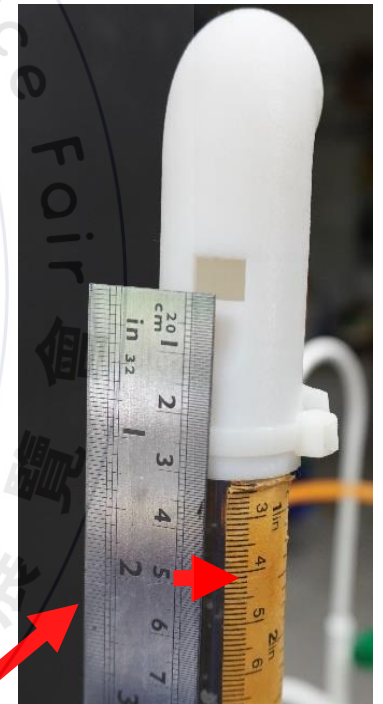
圖18、實體空氣柱長度須修正增加0.9cm
