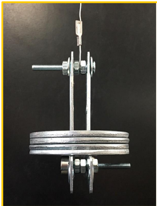
圖(11) 懸掛重物近拍側面圖 T型角鐵和金屬環垂直
