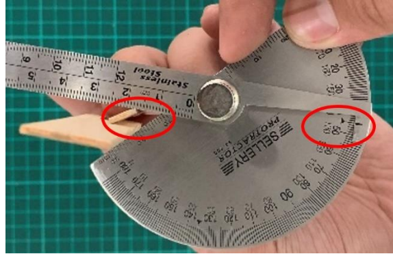
▲圖 7 分度規確認葉片 45 度夾角圖
