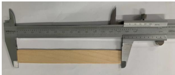
▲圖 1 游標尺量測冰棒棍圖
