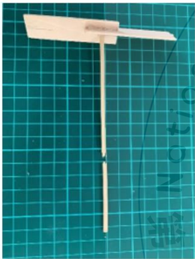
圖10 竹籤當尾桿 竹蜻蜓斷裂圖
