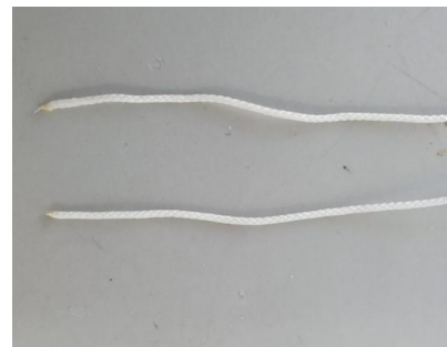
▲圖 23 漁網線切面火燒後壓實圖
