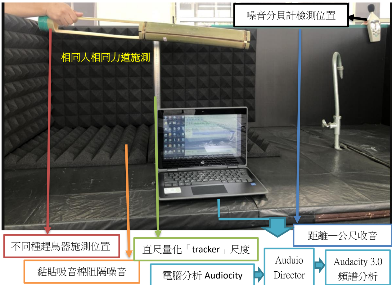
圖 12: 自製鄒族手持趕鳥器隔絕收音組設備
