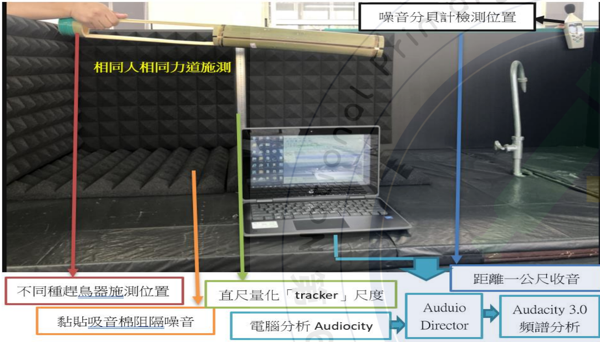
圖4: 自製鄒族手持趕鳥器隔絕收音組設備
