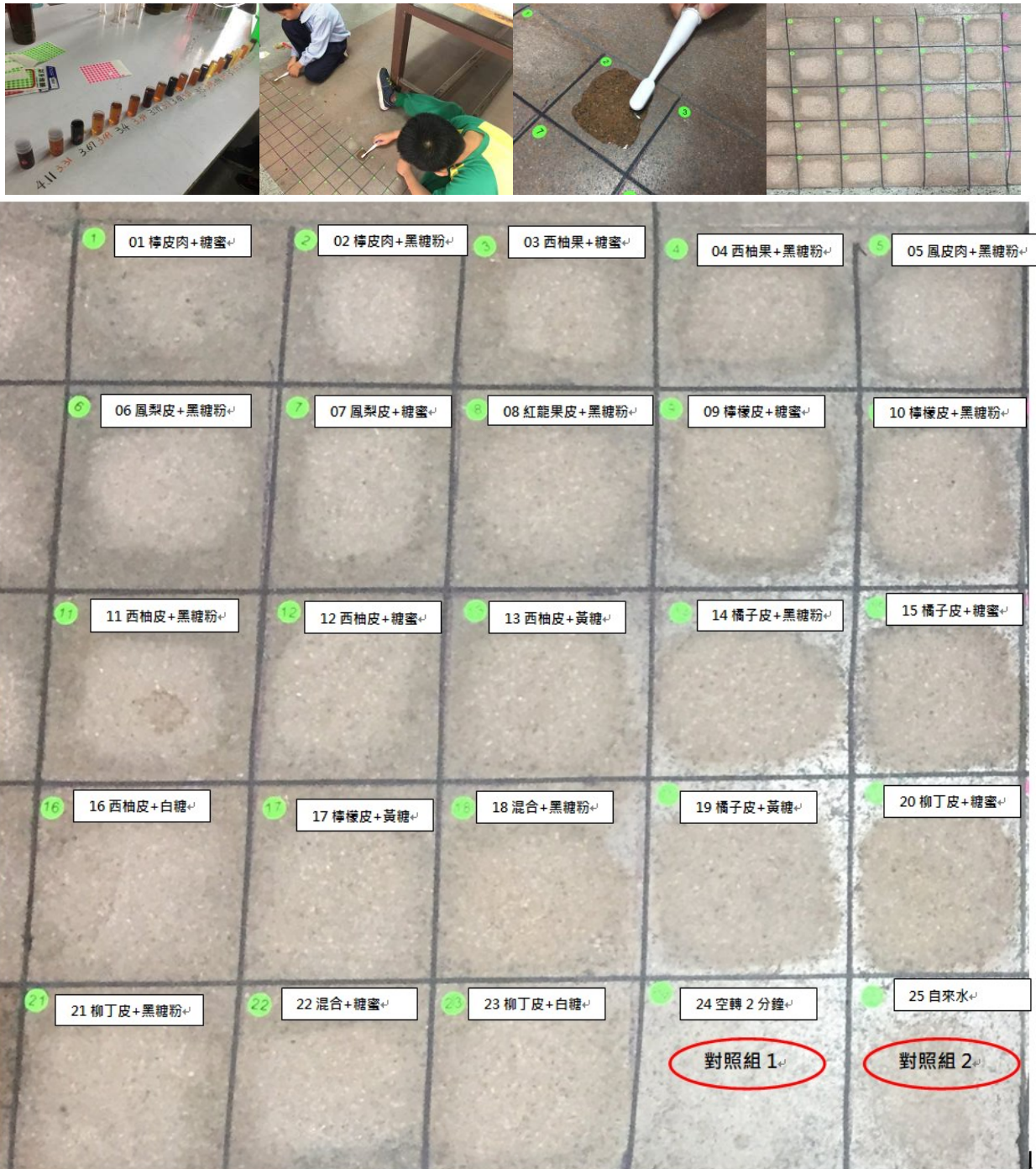
圖8：果皮酵素原汁以電動牙刷刷洗地板與自來水、空轉2分鐘實驗結果對照圖
