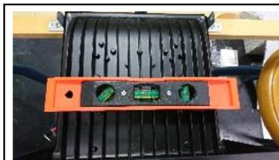
用水平儀測量確定 LED 燈是平的
