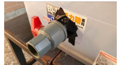
圖 4-5-1 沙池傾瀉裝置
