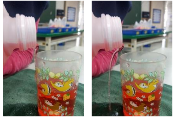
圖 6 編號 5 瓶子回漏情形
