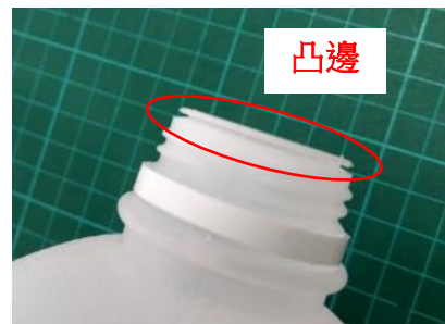
圖 8 編號 3 號瓶口結構-凸邊
