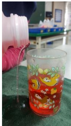
圖 13 沒有凸邊設計及未加上自製環狀套環的瓶口回漏情形
