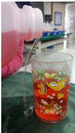
圖 13 沒有凸邊設計及未加上自製環狀套環的瓶口回漏情形
