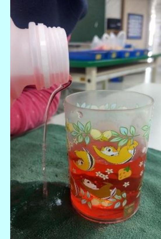
未加上自製環狀套環的瓶口回漏情形
