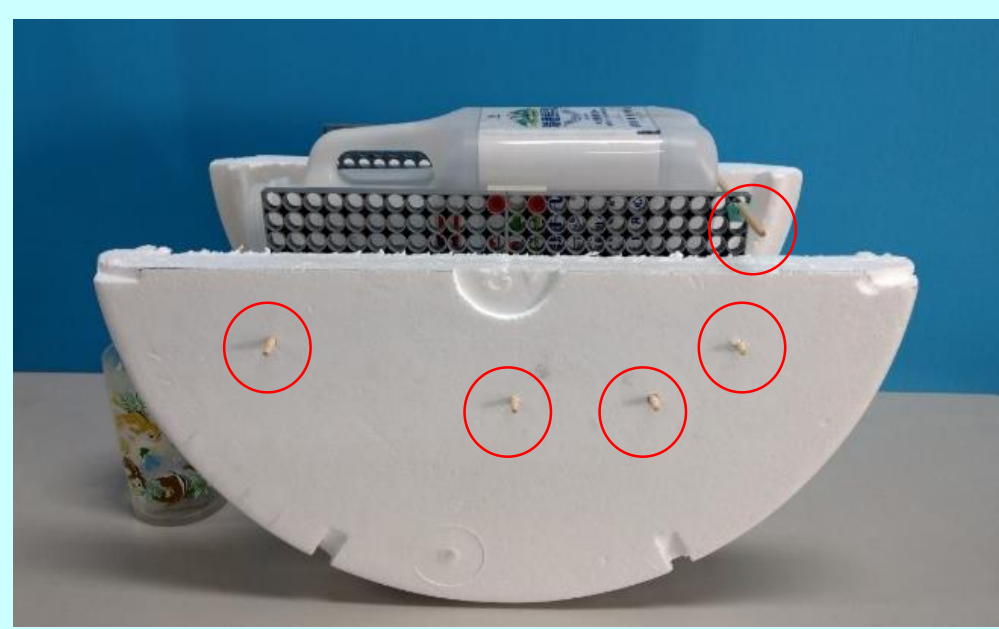
5個支撐點的第二代結構
