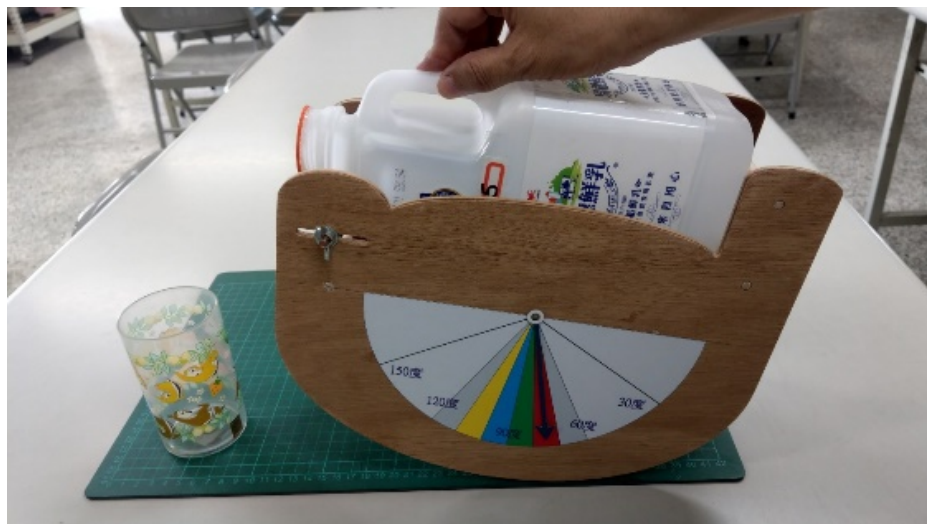
圖 33 增加角度顏色區塊的第四代「傾倒輔助架」
