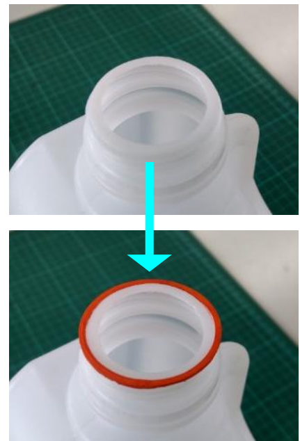
圖 28 瓶口增設凸邊結構
