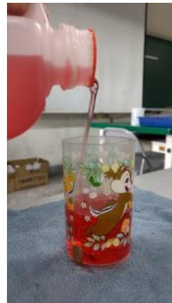
圖 14 加上自製環狀套環不會再有回漏情形
