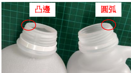
圖 7 瓶口邊緣結構
