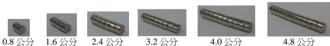
圖 4-12 不同長度的磁鐵攪拌棒。
