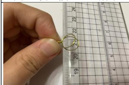
圖 44 用尺將線圈打開成 30°
