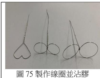
圖 75 製作線圈並沾膠
