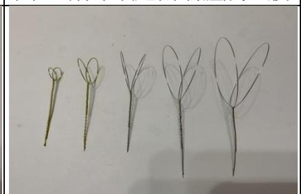
圖 46 完成不同直徑夾角線圈
