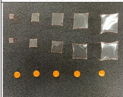
圖 22 等待膜面乾燥固化
