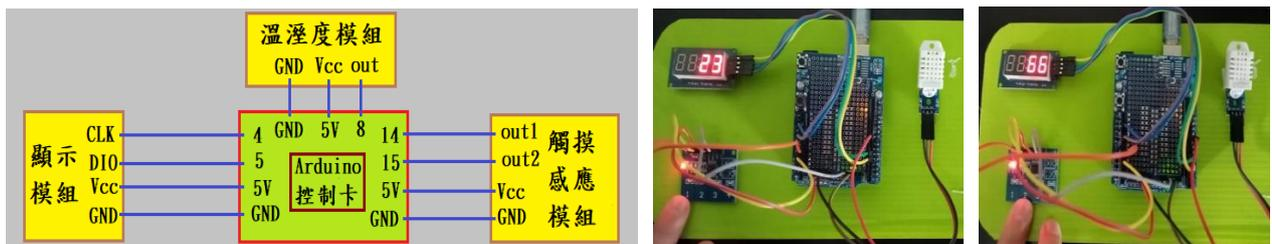
圖 13：溫度、觸摸、顯示模組組合測試線路圖及測試圖。左圖為溫度，右圖為濕度
