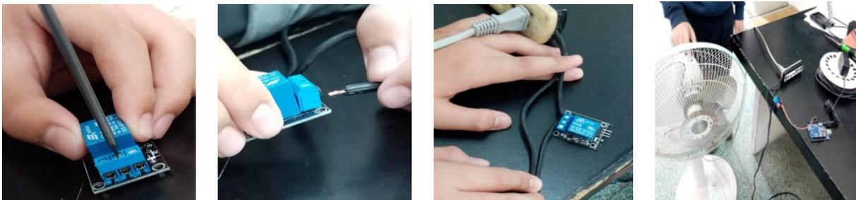
圖 7：Relay 繼電器控制風扇工作圖
