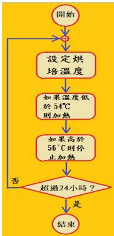
圖 19：傳統烘培程式流程圖
