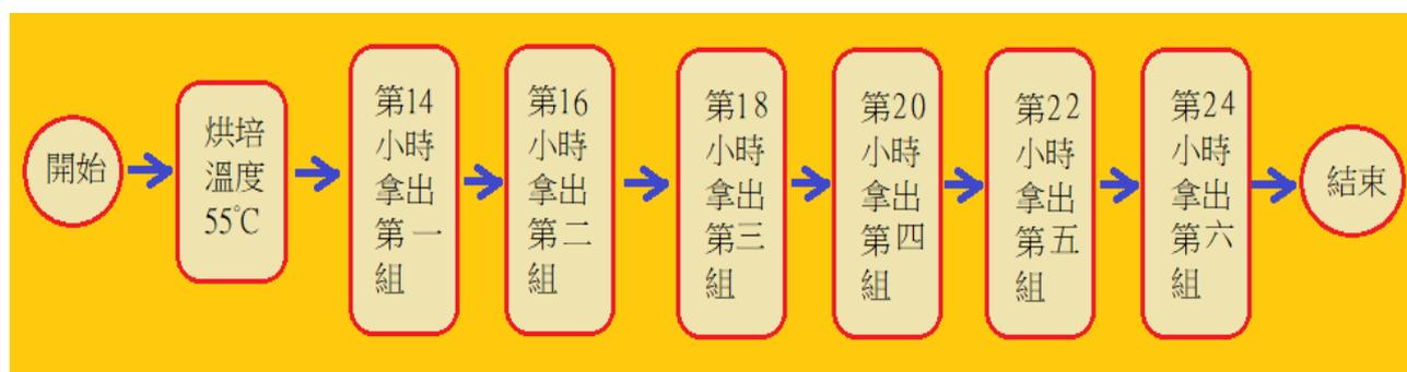
圖 21：乾度烘培實驗流程圖
