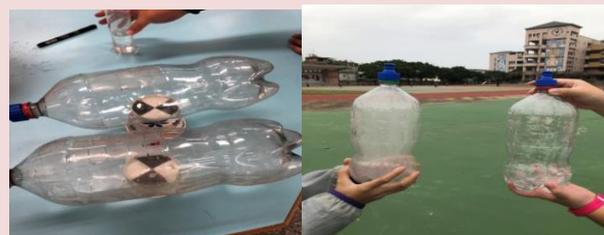
▲(圖 10) 相對減壓雲霧產生實驗利用 Secchi Disk 來量化記錄雲霧延遲時間
