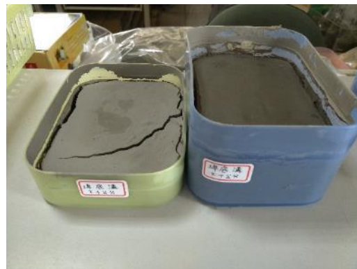
照片 49 埤底溝地表下層 10 公分的取樣泥裂模擬實驗。
