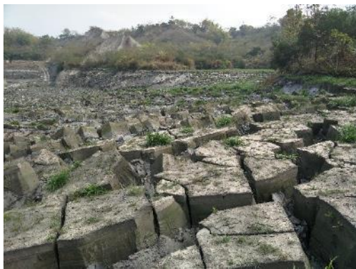
照片 59 牛埔農塘北邊的開挖造成南邊、東邊和西邊的泥裂失去重心而往北邊傾斜。
