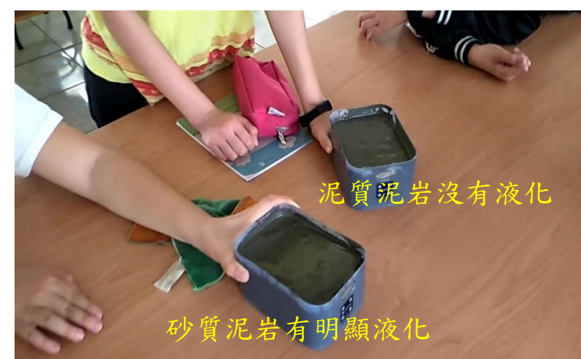
照片63 左邊的砂質泥岩在晃動後有明顯的液化現象，右邊泥質泥岩就沒有。
