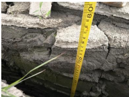
照片 42 下游埤底溝的泥裂深度也不超過一公尺。
