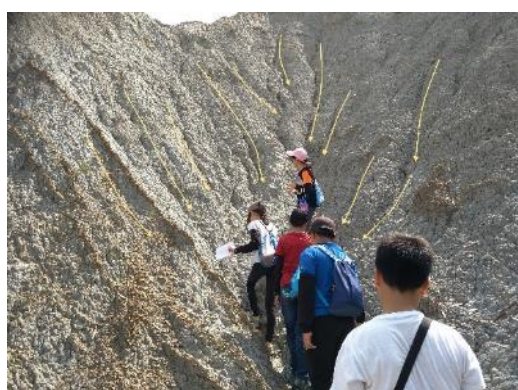
照片 13 牛埔農塘的泥岩邊坡可以發現許多蝕溝，侵蝕量應該不小。
