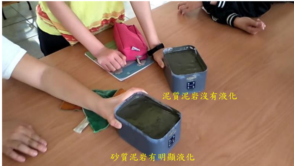
照片 63 左邊的砂岩泥質在晃動後有明顯的液化現象，右邊泥質泥岩就沒有。
