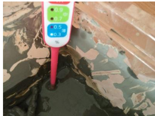
照片 50 牛埔農塘的泥岩鹽度為 0.3。 照片 51 埤底溝的泥岩鹽度也是 0.3。
