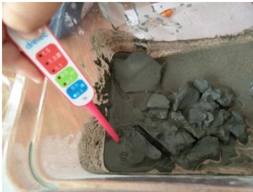
照片 50 牛埔農塘的泥岩鹽度為 0.3。 照片 51 埤底溝的泥岩鹽度也是 0.3。
