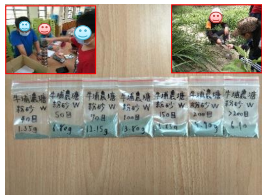
照片 52 牛埔農塘西邊表層粉砂之粒徑分布
