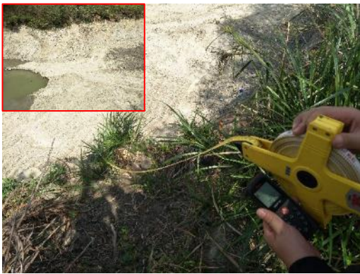
照片 32 實際到達農塘開挖點附近測量湖底到湖面的深度，約 11.3 公尺。
