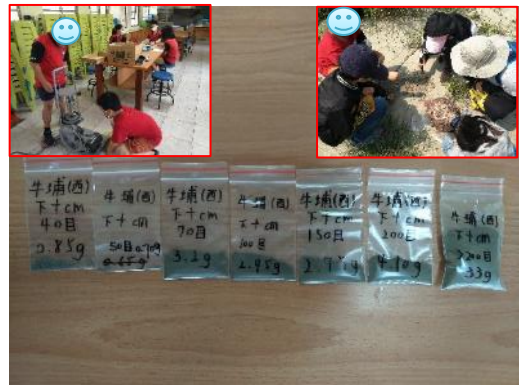
照片 53 牛埔農塘西邊表層下 10 公分砂質泥岩之粒徑分布
