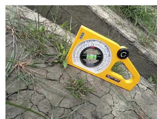
照片61 崩塌的泥裂傾斜角可達30度或更大。
