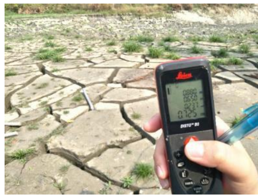
照片 41 牛埔農塘的泥裂深度都沒有超過一公尺。
