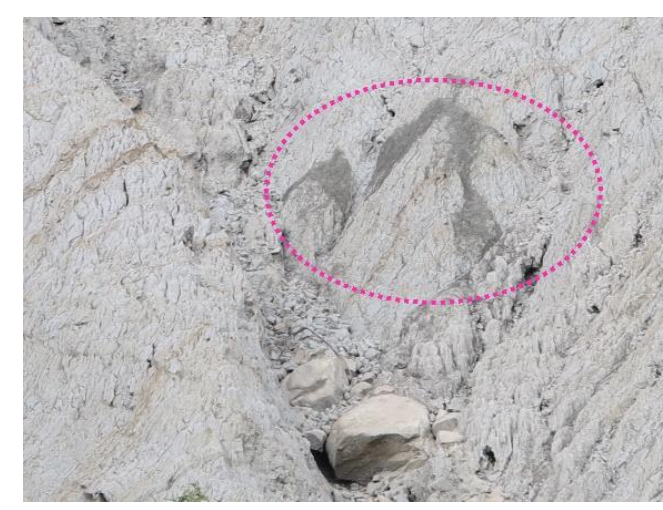
照片24 農塘西邊的泥岩邊坡可以發現一些明顯的黑色斷層泥。
