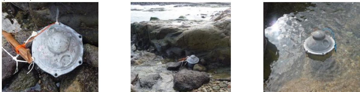
◎增加繩子強度 ◎選擇大岩石後方的位置 ◎漲潮時可以淹到海水
