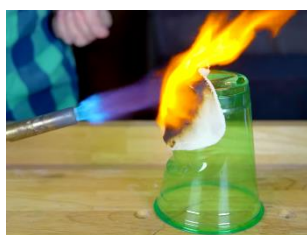
圖 9：將自製星光放在塑膠杯上加熱，塑膠杯沒有受熱融化。
