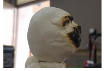
圖 48：糯米膠滑石粉燒後會焦黑凸起膨大。
