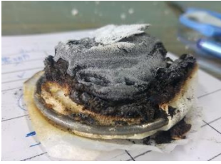
圖 45：燒十分鐘的糯米膠滑石粉膨的非常高。
