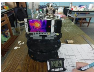
圖 21：以熱像儀測量石塑黏土的上升溫度。
